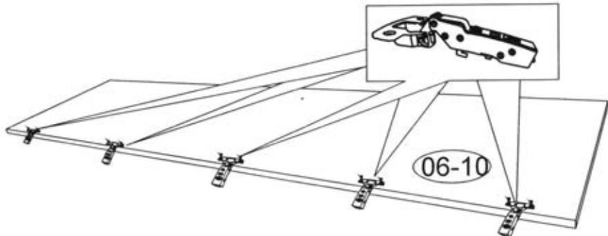
Дверь 06-10 осторожно уложить на прокладочный материал и установить четырехшарнирные петли К-0. Крепить петли к двери на шурупы 4x16.
