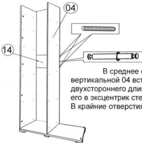
В среднее отверстие на пласти стенки вертикальной 04 вставить шток эксцентрика двухстороннего длинной стороной, вставив его в эксцентрик стенки 14 и зафиксировать. В крайние отверстия вставить шканты 8x60.
