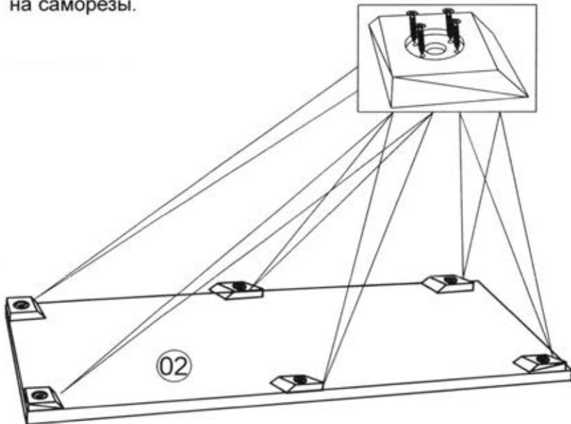
Установить стенку горизонтальную нижнюю 02 в нужное место. В гайки вернуть соединительные винты при помощи отвертки до упора по часовой стрелке.
