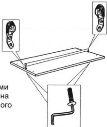
Полки 10 оборудовать штангами с штангодержателями, закрепив их на винты 6x30 при помощи шестигранного ключа.
