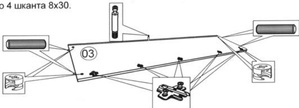
В отверстия на пласти стенки вертикальной 04 установить 4 эксцентрика. В отверстия на торцевых кромках установить 4 шкантa 8x30.
