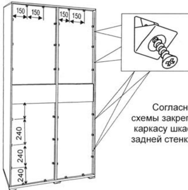
Согласно приведенной выше схемы закрепить задние стенки к каркасу шкафа на соединители задней стенки с шурупом.
