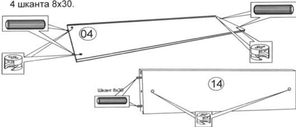
Стенку вертикальную соединительную 14 оборудовать двумя эксцентриками. В отверстия на торцевой кромке с одной стороны установить 2 шкантa 8x30.
