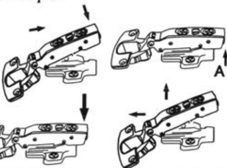
Схема монтажа петли.
