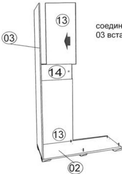
В пазы стенки вертикальной соединительной 14 и стенки вертикальной 03 вставить заднюю стенку 13.
