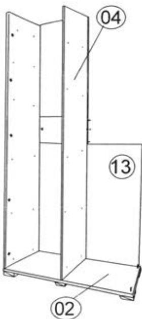
В пазы стенки вертикальной соединительной 04-10 и стенки горизонтальной 02-10 вставить заднюю стенку 13.
