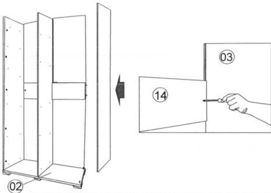
Установить стенку вертикальную 03 отверстиями на соединительные винты стенки горизонтальной 02. Обратить внимание, чтобы шканты стенки 03 вошли в отверстия стенки 02, шканты стенки 14 вошли в отверстия стенки 03 Соединительный винт стенки 03 вошел в отверстие в кромке стенки 14, стенки задние 13 вошли в паз стенки 03. Зафиксировать стенку 03 к стенке 02 и стенке 14 на эксцентриковую стяжку.
