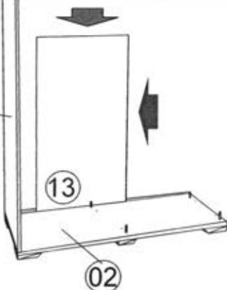
Установить стенку вертикальную соединительную 14 отверстием на соединительный винт стенки вертикальной 03-10 таким образом, чтобы верхняя кромка задней стенки 13 вошла в паз стенки 14, шканты 8x30 вошли в отверстия на стенке 03-10. Крепить стенку 14 к стенке 03-10 на эксцентриковую стяжку.
