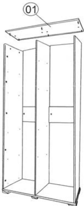
Приставить стенку горизонтальную верхнюю 01 соединительными винтами к отверстиям каркаса шкафа, обеспечив входжение фурнитуры в отверстия сопрягаемых деталей. Крепить стенку горизонтальную 01 к каркасу шкафа на эксцентриковую стяжку.
