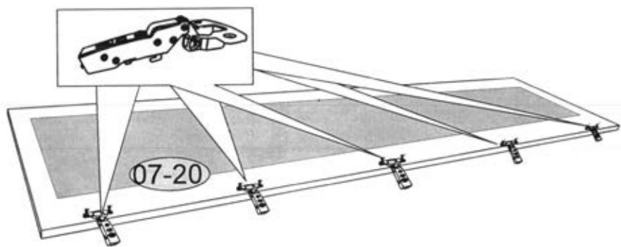
Дверь 07-20 с наклеенным внутри зеркалом осторожно уложить на прокладочный материал и установить четырехшарнирные петли К-0. Крепить петли к двери на шурупы 4x16.
