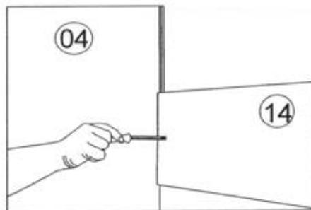
Установить стенку вертикальную соединительную 14 отверстием на соединительный винт стенки вертикальной 04 таким образом, чтобы верхняя кромка задней стенки 13 вошла в паз стенки 14, шканты 8x60 вошли в отверстия на стенке 14. Крепить стенку 14 к стенке 04 на эксцентриковую стяжку.
