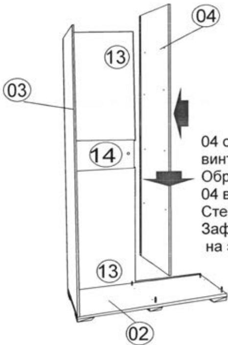
Установить стенку вертикальную 04 отверстиями на соединительные винты стенки горизонтальной нижней 02. Обратить внимание, чтобы шканты стенки 04 вошли в отверстия стенки 02. Стенки задние 13 вошли в паз стенки 04. Зафиксировать стенку 04 к стенке 02 на эксцентриковую стяжку.
